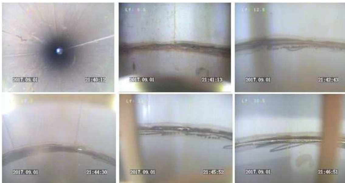
Figure 1 : Joints du tube plein
