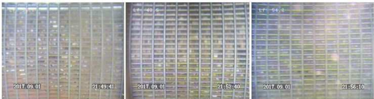
Figure 5 : Massif filtrant observable à travers les crépines
